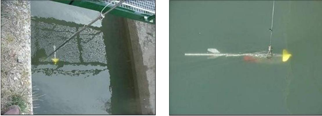
Fig 5: Molinete de hélice sumergido con barra graduada (A) y con cable lastrado (B)
