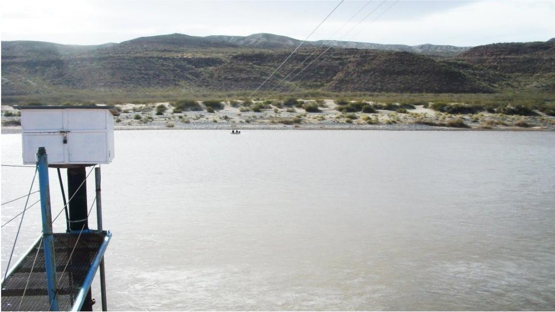
Fig 17: Aforo con equipo Doppler – Estación La Higuera.
