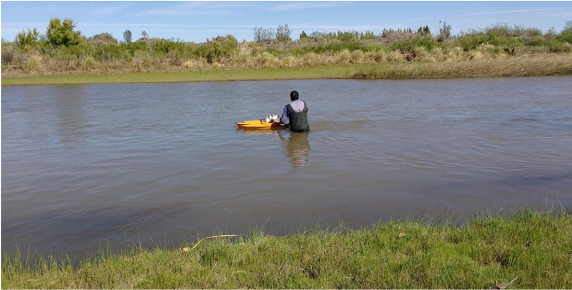
Fig 15: Aforo con equipo Doppler – Estación Portezuelo Grande.
