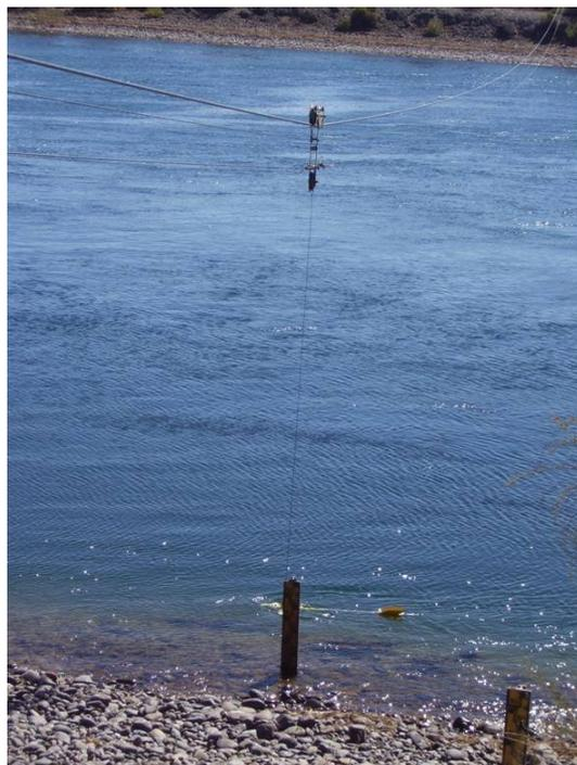
Fig 13: Aforo con molinete – Estación de aforo El Chañar.
